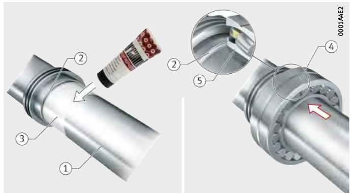
Bild 14 Montagepaste aufbringen, Lager aufschieben
